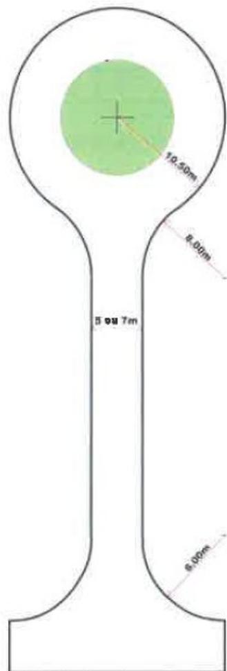
Figure 1 - Principe de retournement de type « raquette »
